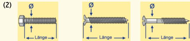
z. B. Spannplattenschrauben
