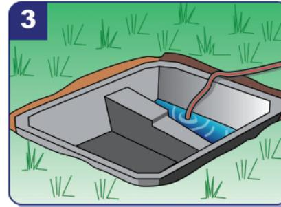
Ca. 60 % Wasser einfüllen, damit sich das Becken nicht nach oben drückt. Nun die Zwischenräume mit Sand füllen und einschlämmen.
