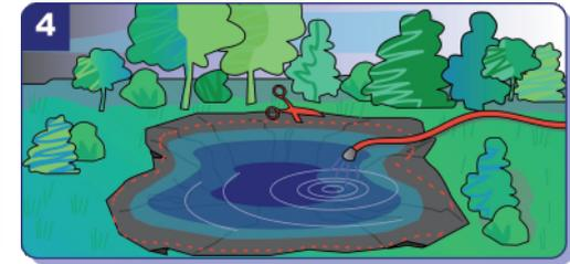
Dann wird der Teich mit Wasser gefüllt und die Folie mit einem überstehenden Rand von mindestens 20 cm abgeschnitten.
