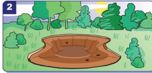
Der Boden sollte mit einer ca. 5 cm dicken Sandschicht gefüllt werden, nachdem die Teichmulde ausgehoben ist.
